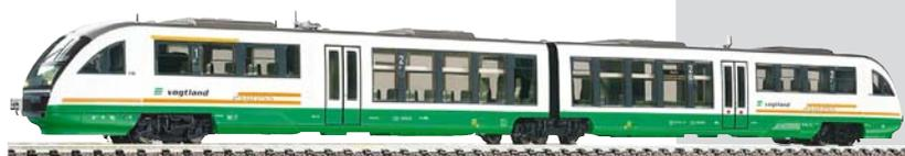
Der Diesellokomotive BR 642, auch Desiro genannt, ist der am meisten eingesetzte Triebzug-Typ der privaten Eisenbahngesellschaft Vogtlandbahn GmbH. Das zwei-teilige Modell besitzt eine Kurzkupplung über ein kulissengeführtes Jakobs-Dreh-gestell zwischen den Fahrzeugen. Ein Adapter mit Aufnahmeschacht nach NEM 355 sowie PROFI-Kupplungen 9545 für Mehrfachtraktion liegen dem Modell bei.
